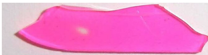
Figura 1: Amostra de Xerogel apresentando um local descolorido pela luz solar
